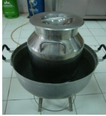
2. ชุดพาสเจอร์ไรส์ (แบบตุ๋น) แบบที่ 1
