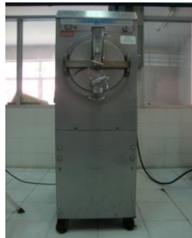
6. เครื่องปั่นไอศกรีม ขนาด 10 กิโลกรัม แบบมีคอมเพรสเซอร์ในตัว
